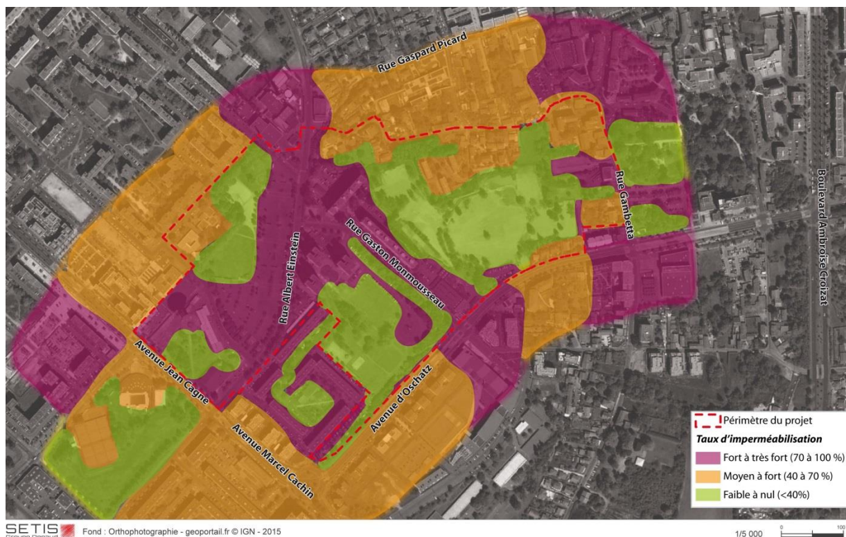
État de l'imperméabilisation dans l'emprise du projet et à ses abords
